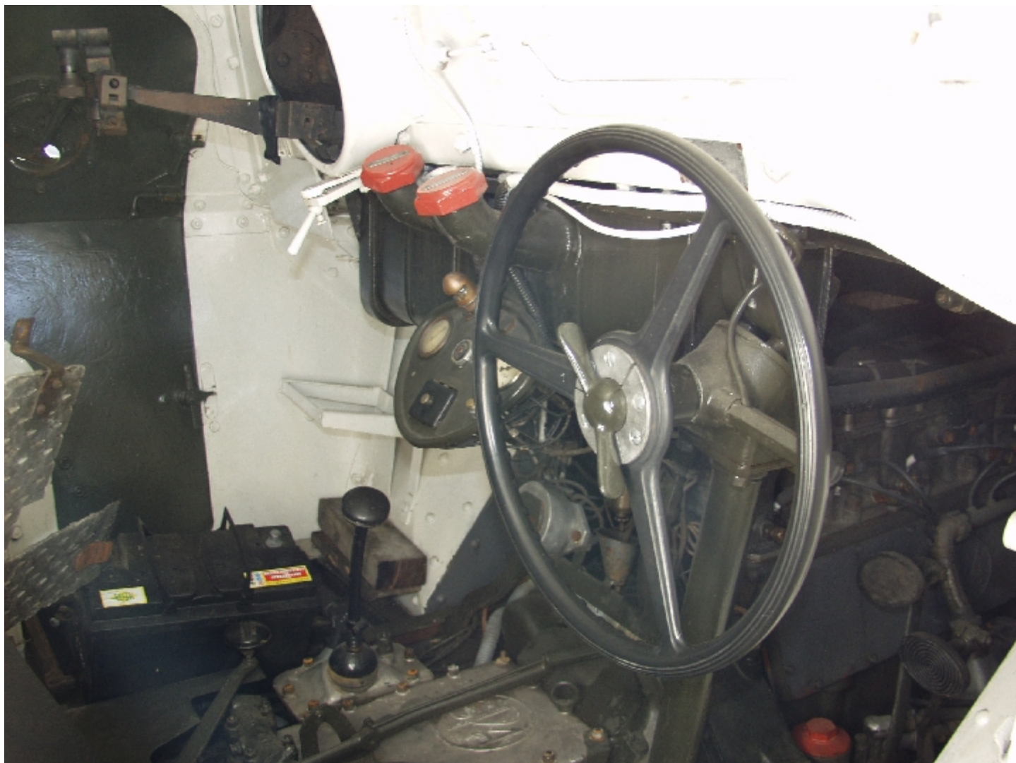
Il posto del secondo pilota visto lateralmente. L'orientamento del piantone dello sterzo è identico a quello del pilota ma il volante ha tre sole razze. Si intravedono anche il blocco della trasmissione ed il propulsore oltre che i due bocchettoni completi di tappi del serbatoio di compensazione ed il cruscotto. Il vano delle batterie è aperto. Archivio F. d'Inzéo
