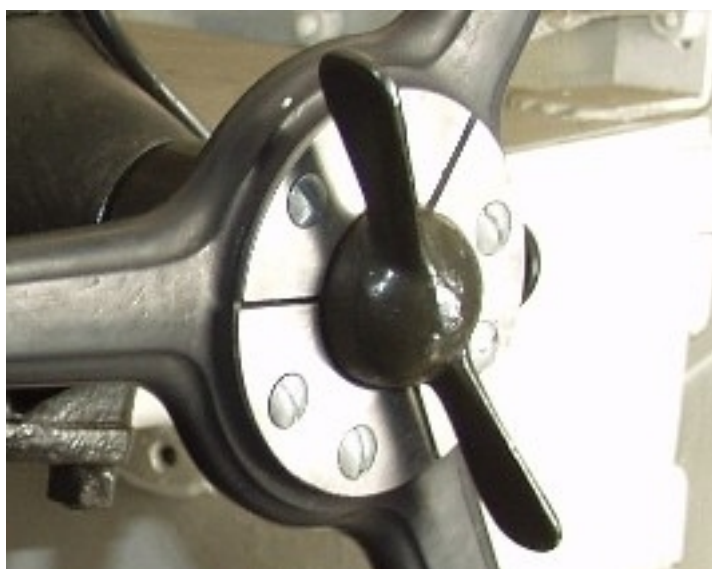
Particolare della farfalla che assicura lo sterzo al piantone
