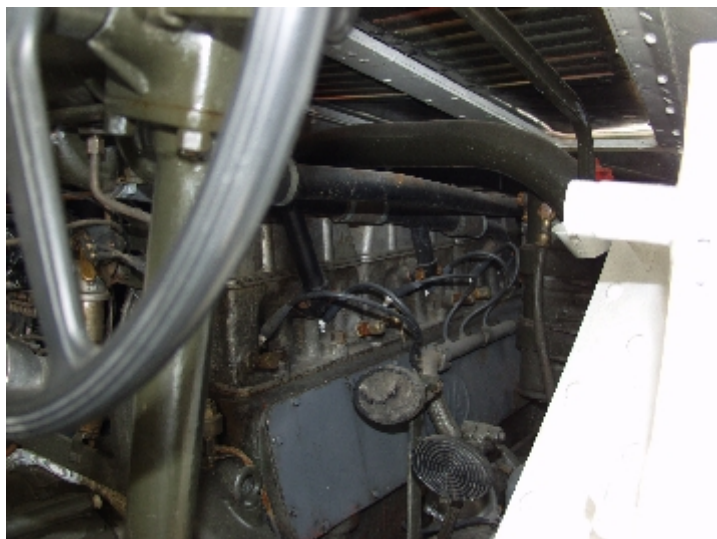
Il lato destro del gruppo motopropulsore con bene in vista la pedaliera e parte del cablaggio
