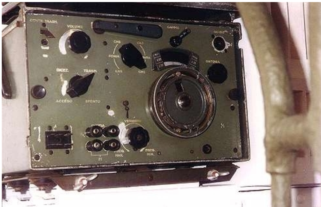
Particolare della radio e del relativo sistema di fissaggio alla parete destra del mezzo rispetto al seggiolino del capo blindo di cui si intravede il traliccio tubolare a a sua volta fissato alla torre
