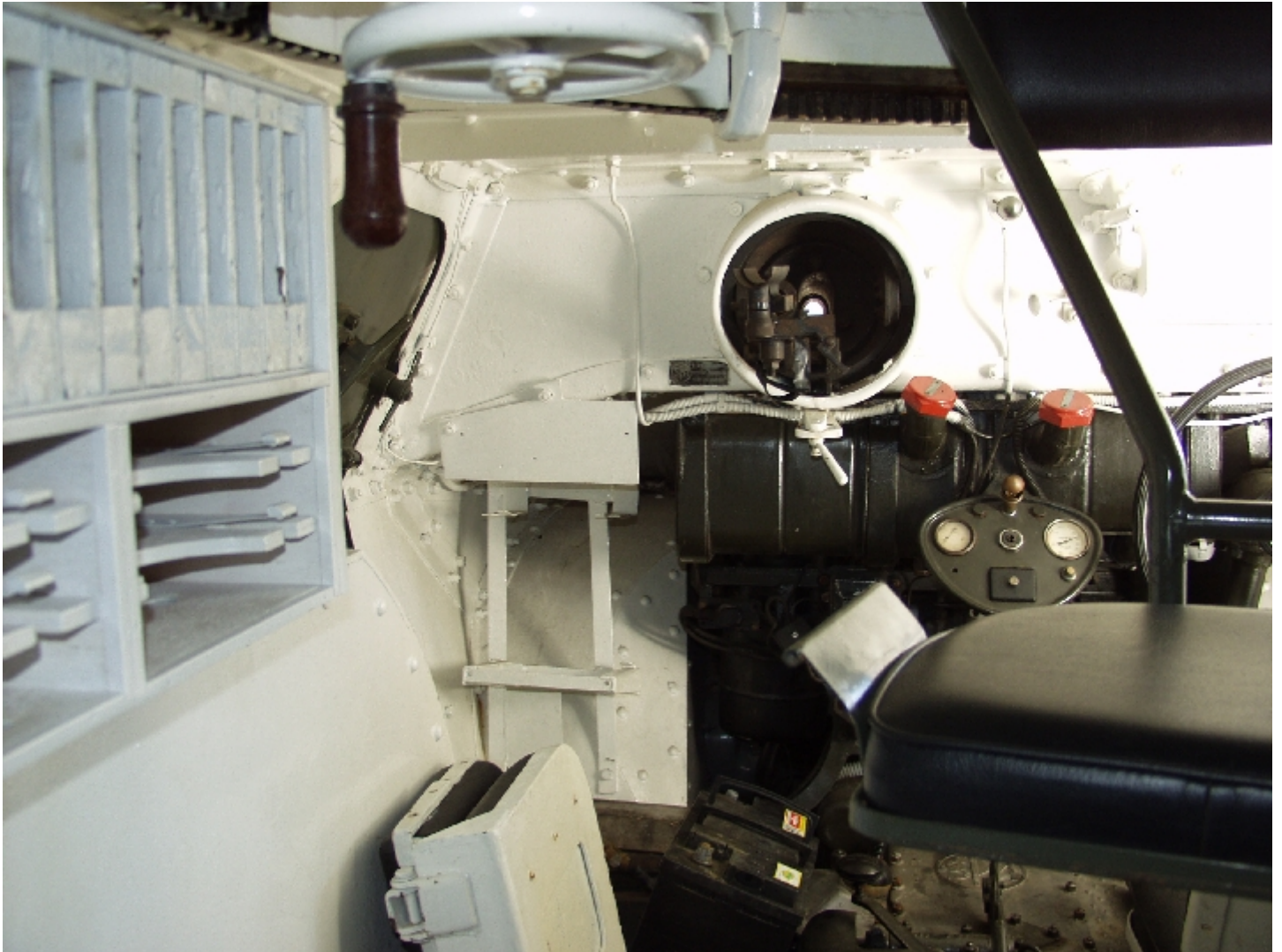
In questa immagine si vede bene lo strapuntino del mitragliere che aziona la Breda da 8mm cosiddetta "in ritirata" e l'alloggiamento della stessa
