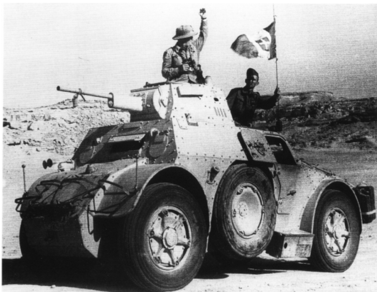
AB 40 con ancora gli indicatori d'ingombro anteriori e con supporti di circostanza per l'alloggiamento di quattro canistri anteriormente. Immagine reperita su Internet
