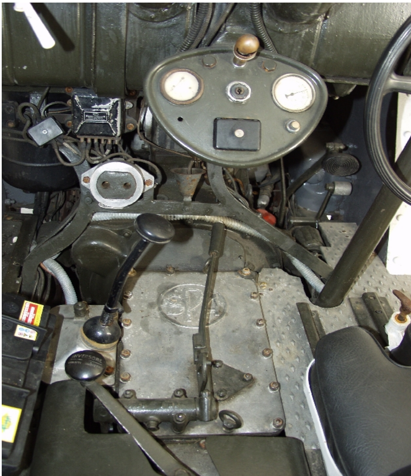
Un'ultima vista d'insieme del posto del secondo pilota che ci mostra con maggiore chiarezza il posizionamento di tutti i comandi a sua disposizione. Ben visibile anche la particolare trama antisdrucchiolo che ricopre le piastre del pagliolo
