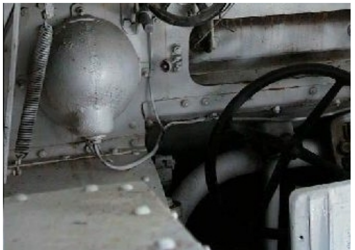
Mancando su questo mezzo le riserve, si ha una migliore visione dell'alloggiamento del fanale e del mollone di ritegno
