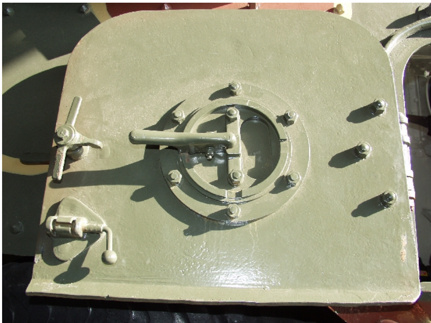
La foto mostra chiaramente sia i meccanismi di chiusura della semi portella superiore sinistra che i leveraggi per l'apertura della feritoia laterale per il tiro con l'armamento individuale o l'osservazione esterna. Sotto due viste di dettaglio
