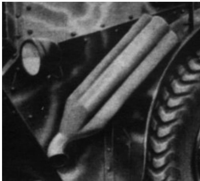
La marmitta adottata per gli ultimi lotti di produzione delle AB 41 e che sarà quella standard per le AB 43
