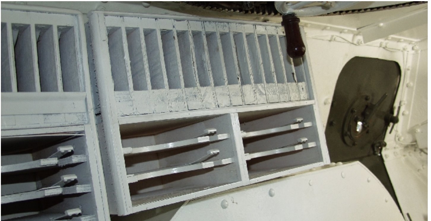
Una vista delle riserve in legno alloggiate sulle pareti laterali veicolo. Quelle ad andamento verticale sono per i caricatori delle Breda da 8mm mod. 38, mentre quelli orizzontali alloggiavano le lastrine della Breda da 20mm mod. 35
