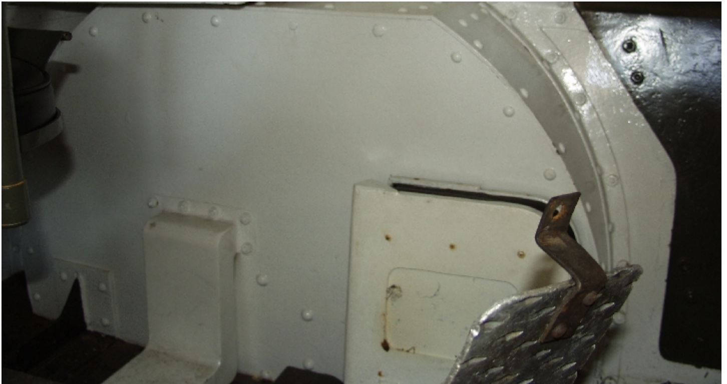
Una vista del del lato interno del passaruota di scorta destro con ben visibile la rivettatura che fissa le varie piastre costituenti la blindatura del veicolo
