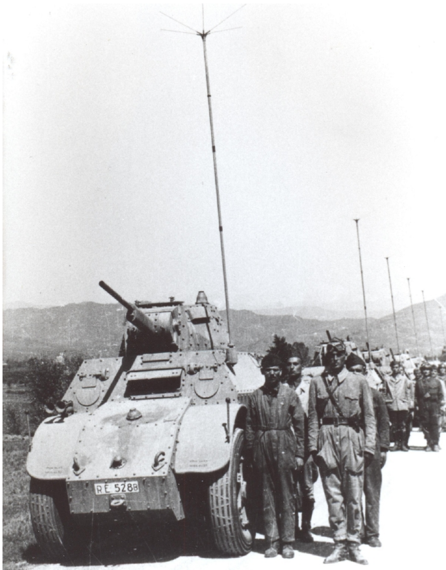
Una colonna di autoblinde 40 di "Nizza" con antenna alla massima estensione (7 metri). In questa configurazione si poteva raggiungere, in fonìa, una copertura di circa 60 km. Archivio Lancia
