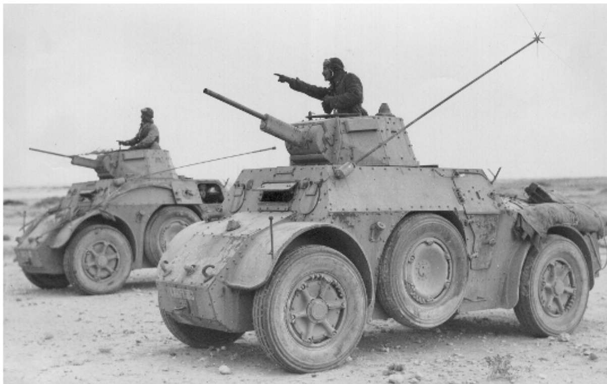
Sezione di blindo del III Gruppo Corazzato "Monferrato" con antenne estese per tre metri. Si possono vedere abbastanza chiaramente i sei steli dell'antenna disposti a raggiera. Archivio Ansaldo (via Pignato)
