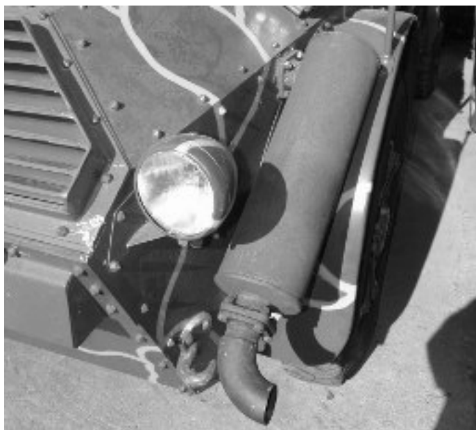
La marmitta usata per le AB 40 e fino ai lotti intermedi di produzione delle 41
