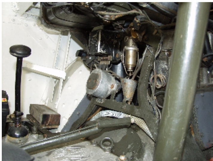
Una vista del traliccio con montata la presa per la messa in moto con il cavo di emergenza
