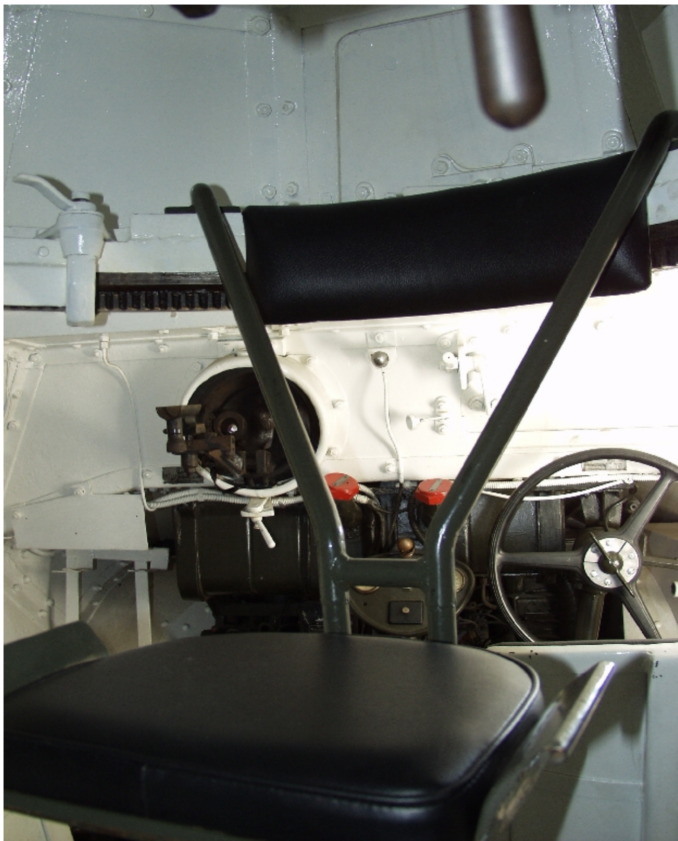
In questa immagine si vede chiaramente e praticamente per intero il sedile del capo blindo imbullonato alla struttura della torretta. Posteriormente in basso il posto del secondo pilota e quello del mitragliere, a sinistra in alto il blocco della torre
